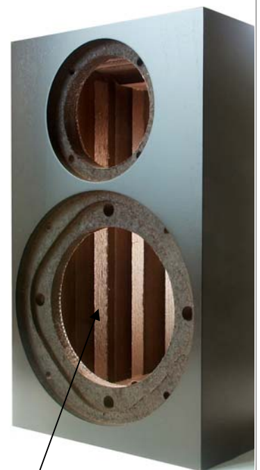
Diffuseurs Ils servent à casser les ondes sonores pour éviter les échos flottants et les ondes stationnaires sans étouffer les micro-informations
