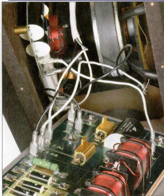
Französisches Know-how: Auf engstem Raum arbeiten der schwere Basstöner und die wertigen Weichen zusammen. Im Hintergrund erkennt man die Gehäuseverstreben und die Bedämpfung.
