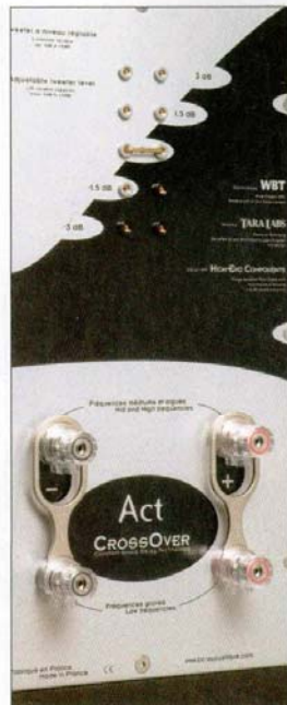
Wahlmöglichkeit: Der Horn­töner kann per Steckbrücke im Pegel angepasst werden.
