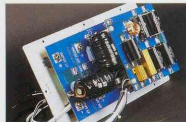
Le voile protège l'arrière du spider et la bobine contre toute intrusion du matériau amortissant. Les 2 selfs sur noyau, l'un monté sur le + l'autre sur le -, sont quasiment insaturables.
