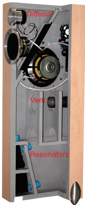
výrazné vnitřní rezonance jsou však tlumeny selektivně použitím výše zmíněných laděných pasivních akustických rezonátorů.
