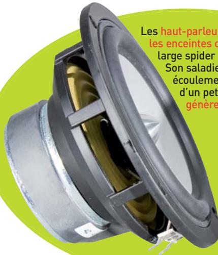
Les haut-parleurs sont les mêmes que ceux utilisés par les enceintes colonne de la série HD-T. On notera le large spider du Woofer. Il lui offre un fort débattement. Son saladier, très largement ventilé, garanti un bon écoulement de l'onde arrière. Le tweeter dispose d'un petit dissipateur pour évacuer la chaleur que génèrent les pics de dynamique.
