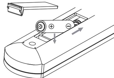
**1** Öffnen Sie die Batteriefachabdeckung der Fernbedienung.
