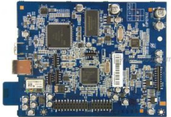
Une puce Burr-Brown PCM9211 (jusqu'à 24 bits à 216kHz), partie supérieure droite de la photo, sert d'interface et de commutateur pour les entrées S/PDIF optiques. Ce circuit numérise également les signaux analogiques provenant de l'entrée Line car l'augmentation du niveau des graves (HRLoudness) est effectuée par traitement numérique.
