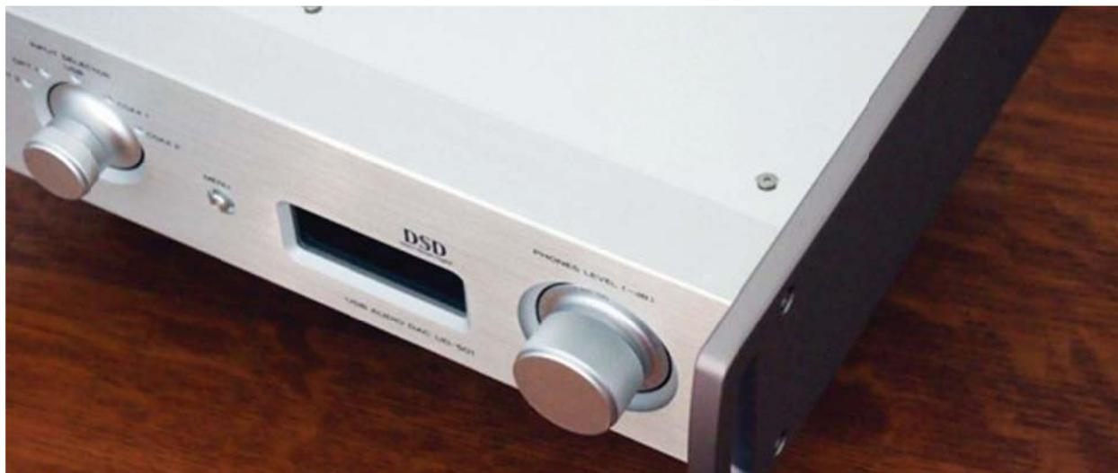
Le bouton de volume dédié à la sortie casque, en aluminium sur la droite possède une longue course graduée de -60 jusqu'à 0DB permettant d'ajuster finement le niveau d'écoute désiré sur une large plage, même sur des casques à basses impédances.
