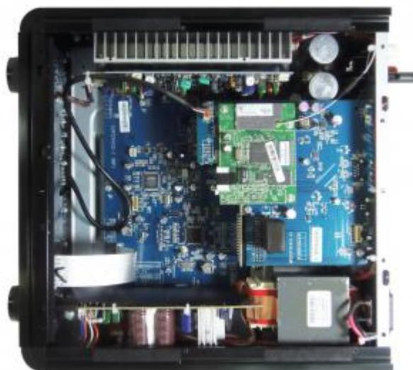
Chacune de ces cartes a un rôle particulier, la carte principale prenant place dans le fond du boîtier tandis que la carte réseau est montée en mezzanine au-dessus d'elle et que la carte d'amplification est piquée perpendiculairement sur cette carte principale au moyen de connecteurs multipoints.
