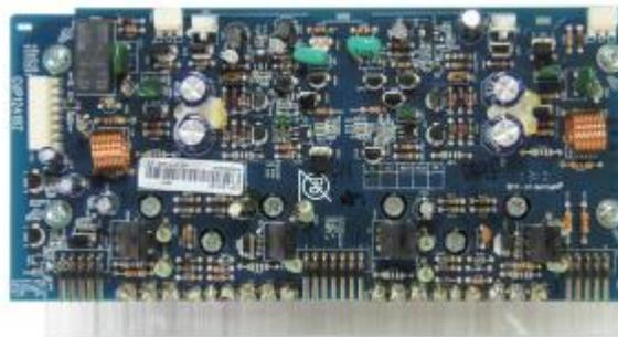
On peut remarquer, sur le visuel ci-dessous, les deux condensateurs de 8200  $\mu\text{F}/56\text{V}$  (une valeur respectable) implantés sur la carte principale au plus près de l'amplification et servant de réservoirs de courant.
