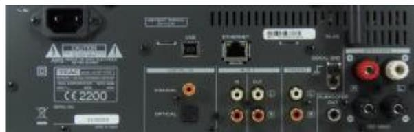
En analogique, on pourra brancher une platine vinyle et une source auxiliaire, cette entrée auxiliaire étant doublée d'une sortie permettant d'enregistrer des signaux et de contrôler le résultat (fonction monitoring).
