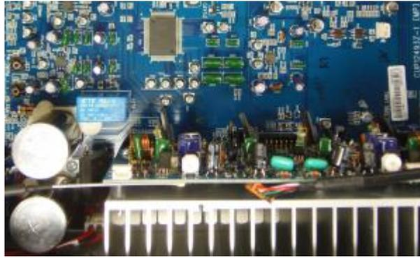
Le gros circuit intégré situé dans le haut du visuel, est un "processeur audio" BD3816K fabriqué par Rohm et permet, entre autres, le réglage du volume et de la tonalité.
