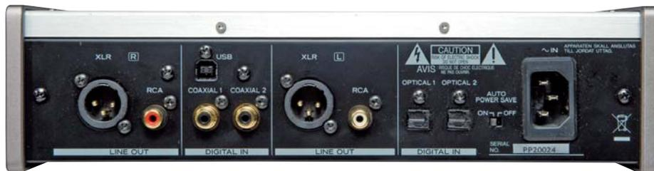
La connectique propose tous les standards généralement utilisés par les mélomanes. L'interrupteur à glissière situé à droite permet de mettre l'appareil en veille si les entrées n'ont pas reçu de signal après un certain laps de temps.
