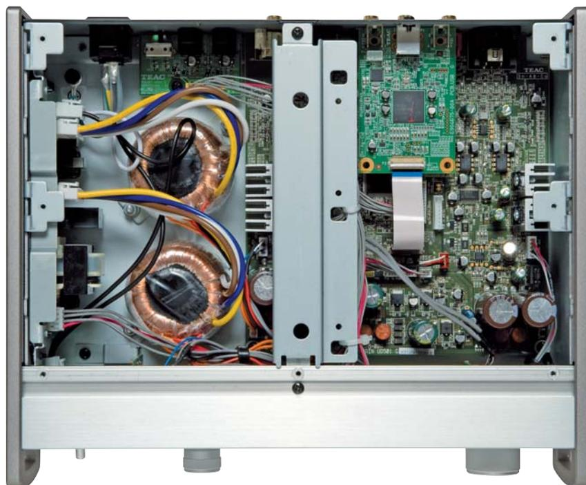
L'implantation des composants semble évidente avec les transformateurs à gauche et les étages audio à droite toute. Le DAC USB est relié par une nappe.
